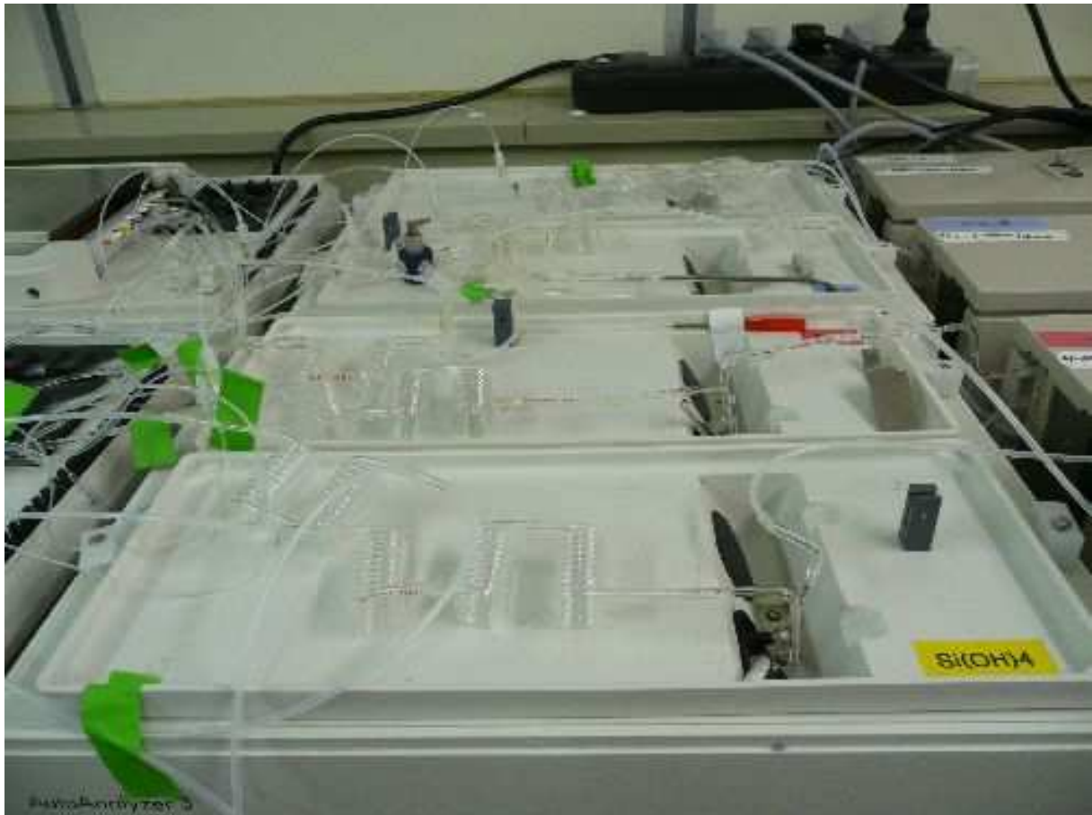
Auto-analyseurs de sels nutritifs : entre les pompes et les colorimètres, le mélange des échantillons et des réactifs.
